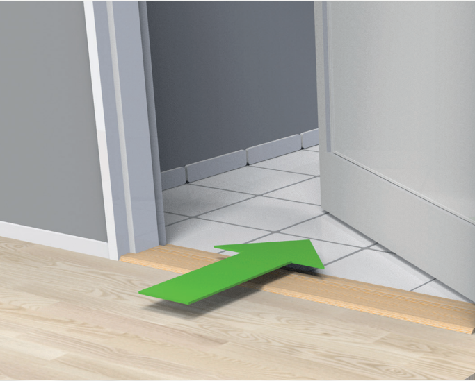
Med EPS lightbeton 360 opbygges gulvet med kun 20 mm spartelmasse, plus keramisk flise-/vinylbelægning. En højde på totalt maks. 30 mm, hvilket stort set er samme højde som bestående bræddegulv.
